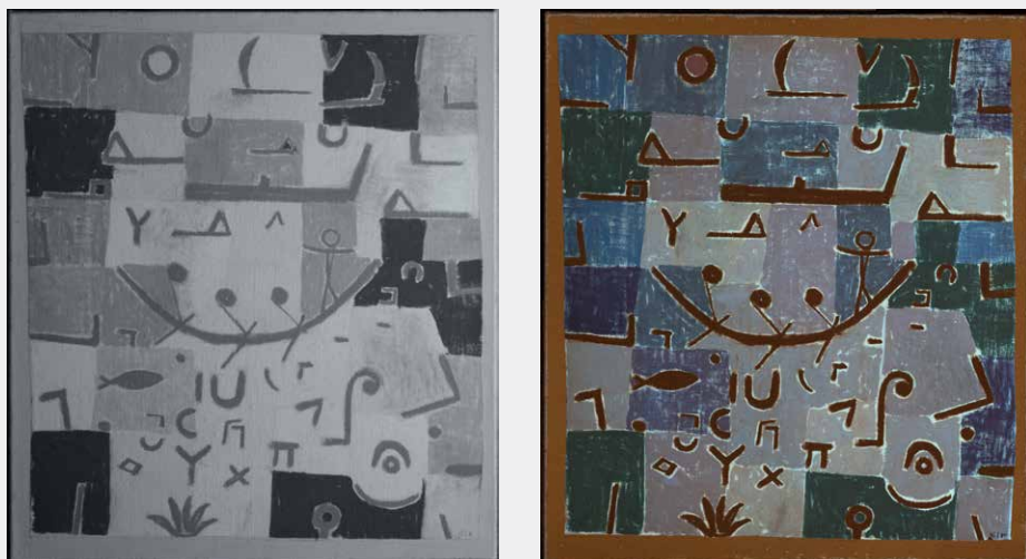
Abb. 2.6 Gesamtaufnahme IR-Reflektografie und UV-Fluoreszenz.
